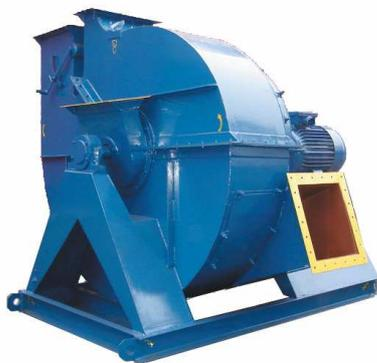
**Дутьевые вентиляторы типа ВДН и ВД предназначены** для перемещения воздуха и невзрывоопасных неагрессивных газоздушных смесей с температурой от -30 до +200°С, запыленностью до 0,2 г/м<sup>3</sup>, не содержащих липких, волокнистых и абразивных включений. Абразивность пыли, содержащейся в перемещаемой среде, и ее склонность к налипанию не должны превышать аналогичных показателей угольной пыли.
