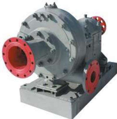
**Предназначены** для перекачивания водоугольной химически нейтральной гидросмеси (рН=6...8) с размерами твердых частиц от 70 до 100 мм (в зависимости от типоразмера), с отношением твердой и жидкой фаз по массе не более Т:Ж 1:3 и содержанием породы в твердой фазе до 40% с температурой от 1°С до 50°С.
