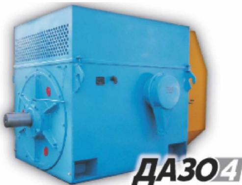
Электродвигатели асинхронные трехфазные с короткозамкнутым ротором закрытые обдуваемые ДАЗО4 предназначены для привода механизмов, не требующих регулирования частоты вращения (насосы, вентиляторы, дымососы и др.).
